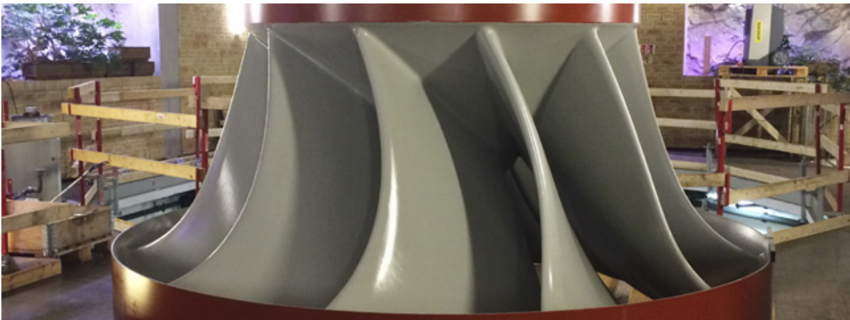
Nytt løpehjul til turbin 3 i Ramfoss, foto Odd Røvang
